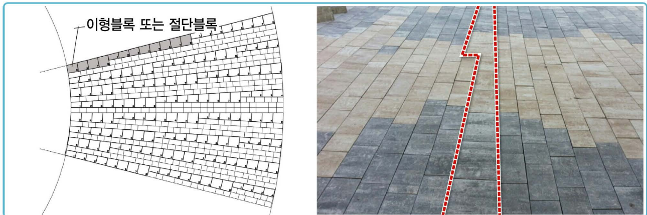
<그림 4-10> 곡선부 이형블록 시공 예시
